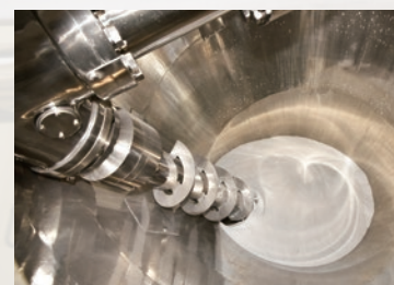
混合機に、塩とさまざまな微量成分を入れて攪拌(かくはん)。振動篩(しんどうふるい)(写真上)を経て、粉末の人工海水ができあがります。
